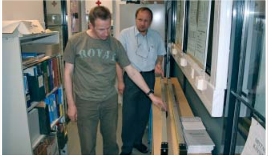
Paavo Rouhiainen ja Markku Poutanen tarkastavat kalibrointiin menossa olevia Viron tarkkavaaituslatoja.
