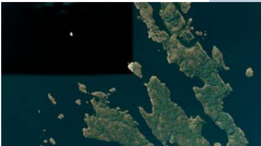
KUVA 3. DMC-kuva Utöstä. Matriisikameran osakuvien yhdistämisessä ilmeni paikoittain ongelmia vesialueella kuvattaessa.
