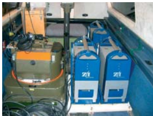
KUVA 9. Leica RC20 -kamera ja DMC-kameran levyjärjestelmä rinnakkain. DMC-kameran kuvat tallentuvat kolmelle erilliselle levyille, jotka kaikki tarvitaan datan purkamisessa. Levyjen siirto ja käsittely on siis massiivista touhua.
